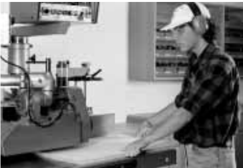
Bild 4: ■ Arbeiten mit dem Vorschubapparat
