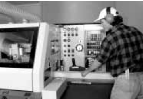
Bild 6: Mechanischer Vorschub (MEC) Beim mechanischen Vorschub wird das Werkstück oder das Werkzeug kraftbetrieben geführt und das Werkstück ist dabei gespannt (z. B. Vierseitenhobelmaschine, Doppelendprofiler, CNC-Bearbeitungszentrum).
