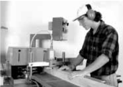
Bild 5: ■ Arbeiten mit dem Schiebeschlitten
