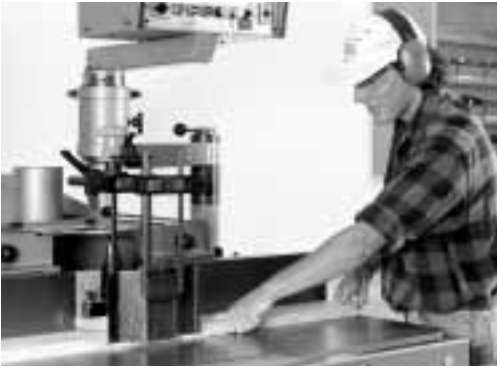
Bild 3: Handvorschub (MAN) Als Handvorschub gilt, wenn das Werkstück von Hand gehalten und geführt wird. Beispiele: ■ Halten und Führen des Werkstücks von Hand
