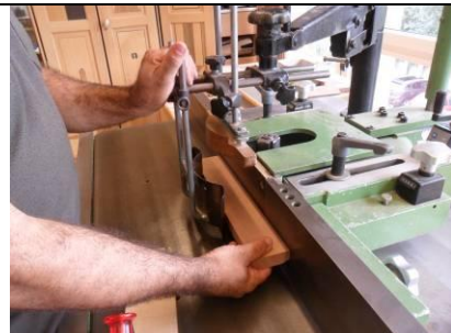
5. Werkstück oberhalb des Fräasers festklemmen
